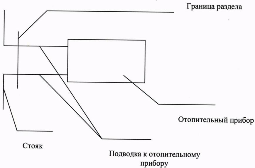
2. По сетям горячего, холодного водоснабжения и стояков: место соединения стояка с подводкой к санитарным приборам
